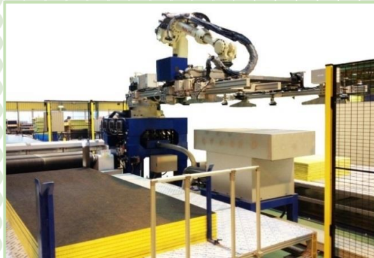
保温材搬送装置
