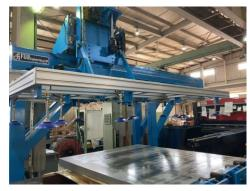
・作業者との"協働作業"が テーマであり、"作業効率"を 損なわず、"安全"に使用できる セーフティシステムを導入
