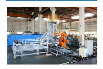
焼入工程において、 加熱後製品の取り出し、 冷却工程への搬送、完成後製品の 次工程への搬送を自動化
