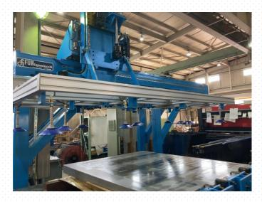
シャーリング工程において、 鋼板をシャーリング装置への搬送及び シャーリング後の集積・搬送工程を自動化
