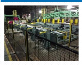
鋼材の切断工程において、 素材のダンバラシ〜搬送〜 切断加工機投入~精度検査~ 取出し後の積込までを一括自動化
